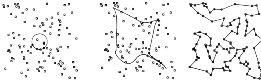
Abb. 4.16 Approximation der optimalen Städtetour durch das Elastische Netz mit den Parametern \sigma(0) = 0,2 , \sigma(7000) = 0,01 , \alpha = 0,2 , \beta = 2,0
