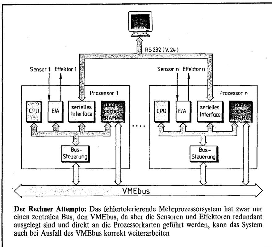
über einen anderen Kommunikationsweg (z. B. den seriellen Bus in VMEbus-Systemen) abgewickelt werden und dem Benutzer der Ausfall mitgeteilt werden. Das Betriebssystem und das jeweilige Anwenderprogramm sind für jeden Prozessor direkt zugreifbar, ohne damit die anderen Prozessoren (Rechnerleistung!) oder seine Daten zu tangieren.
